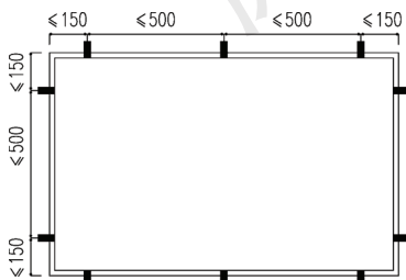
图 6.3.1-2 固定片安装位置
